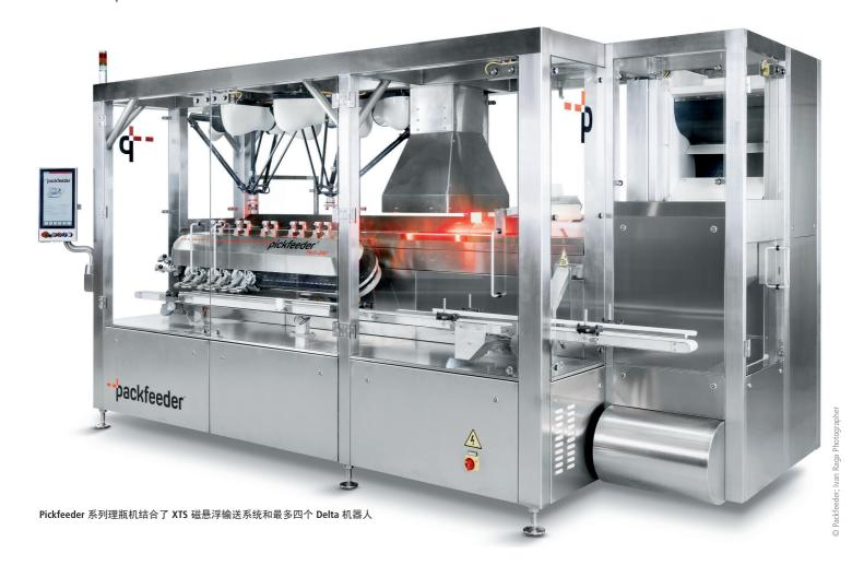
输送带,以便转移到下一台设备。这样可以防止瓶子定位不准确或翻倒。另一个好处是 XTS 能够安装在一个倾斜的位置,使得系统结构特别简单和紧凑。"
